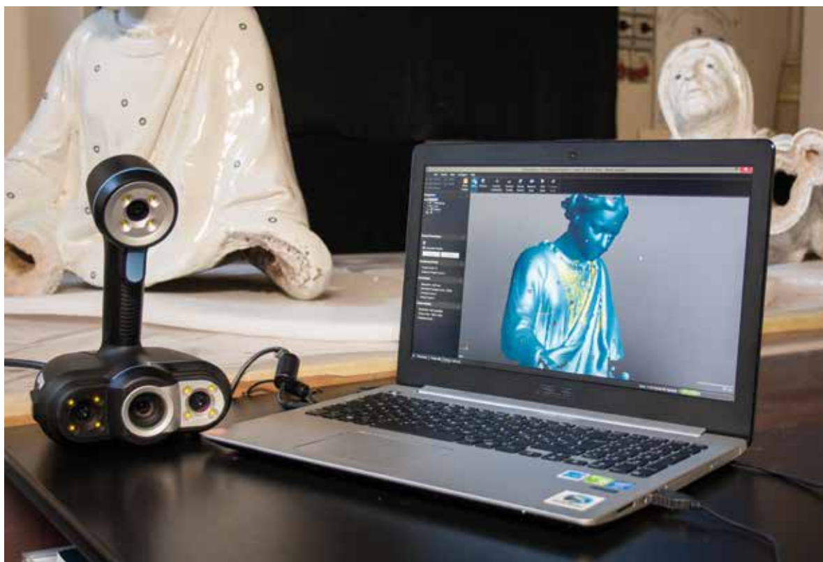
Fig. 2. Scanner 3D "hand-held" durante la ripresa e l'allineamento delle superfici, in tempo reale.
