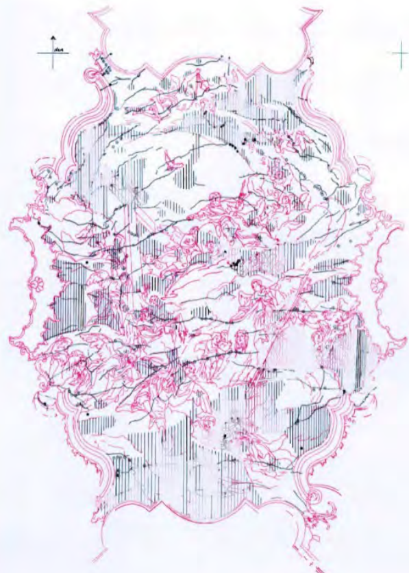
FIGURE 4. WIESKIRCHE, DISTRICT OF STEINGADEN (BAVARIA), FRESCO IN THE CHOIR (J. B. ZIMERMANN, 1749), DRAWING BASED ON A PHOTOGRAPH WITH GRAPHICAL DAMAGE ASSESSMENT AND MAPPING OF RESTORATION INTERVENTIONS, FROM: DIE INES. GESCHICHTE UND RESTAURIERUNG HISTORY AND RESTORATION, ARBEITSHEFTE DES BAYERISCHEN LANDESAMTES FÜR DENKMALPFLEGE, BD. 55, MÜNCHEN 1992.
